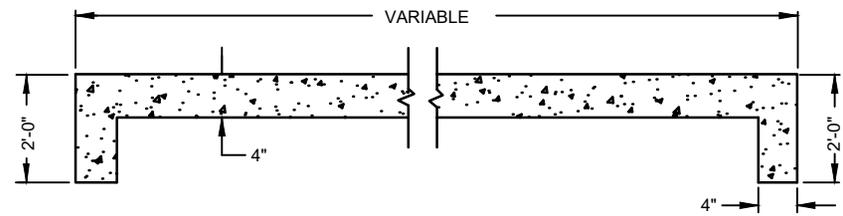
LONGITUDINAL SECTION OF PAVED DITCH
